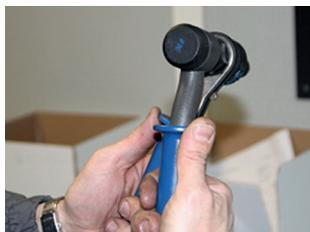
5) Quand l'écrou est serti, remontez le cliquet et continuez le mouvement dans le sens contraire des aiguilles d'une montre pour desserrer.
