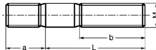
**NB:** Comme le spécifie la DIN 267-2, le filet de l'engagement (a) sera toujours réalisé dans la tolérance SK6 suivant DIN 13-51. Sauf si il est mentionné « Fo » ou « Sn4 », c'est-à-dire sans ajustement du filet.
